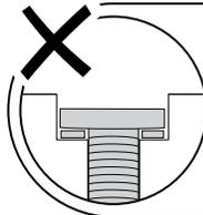
ネジを必要以上に締めないでください。製品を損傷する可能性があります。
